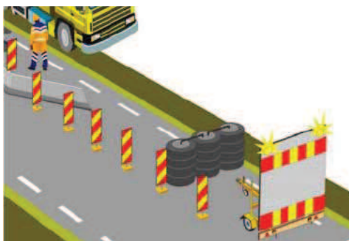
Figur 4.10 Tversgående sikring på kjørebanen, med varslingsutstyr.
